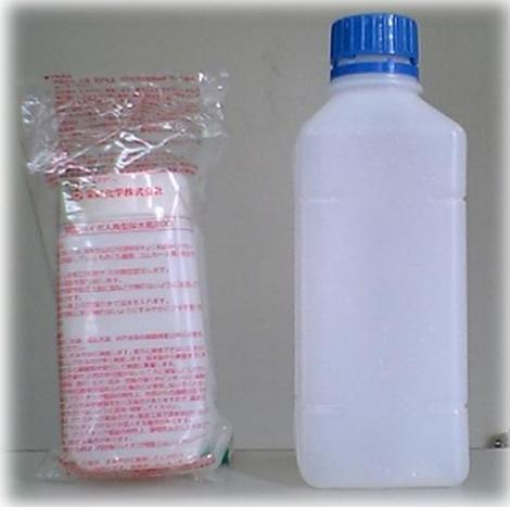
細菌検査用採水瓶 理化学検査用採水瓶
