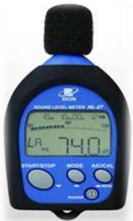
騒音の測定は、日本工業規格C1509に規定する普通騒音計又は精密騒音計を用いてA特性で測定した値をデシベルで表示「dB (A)」します
